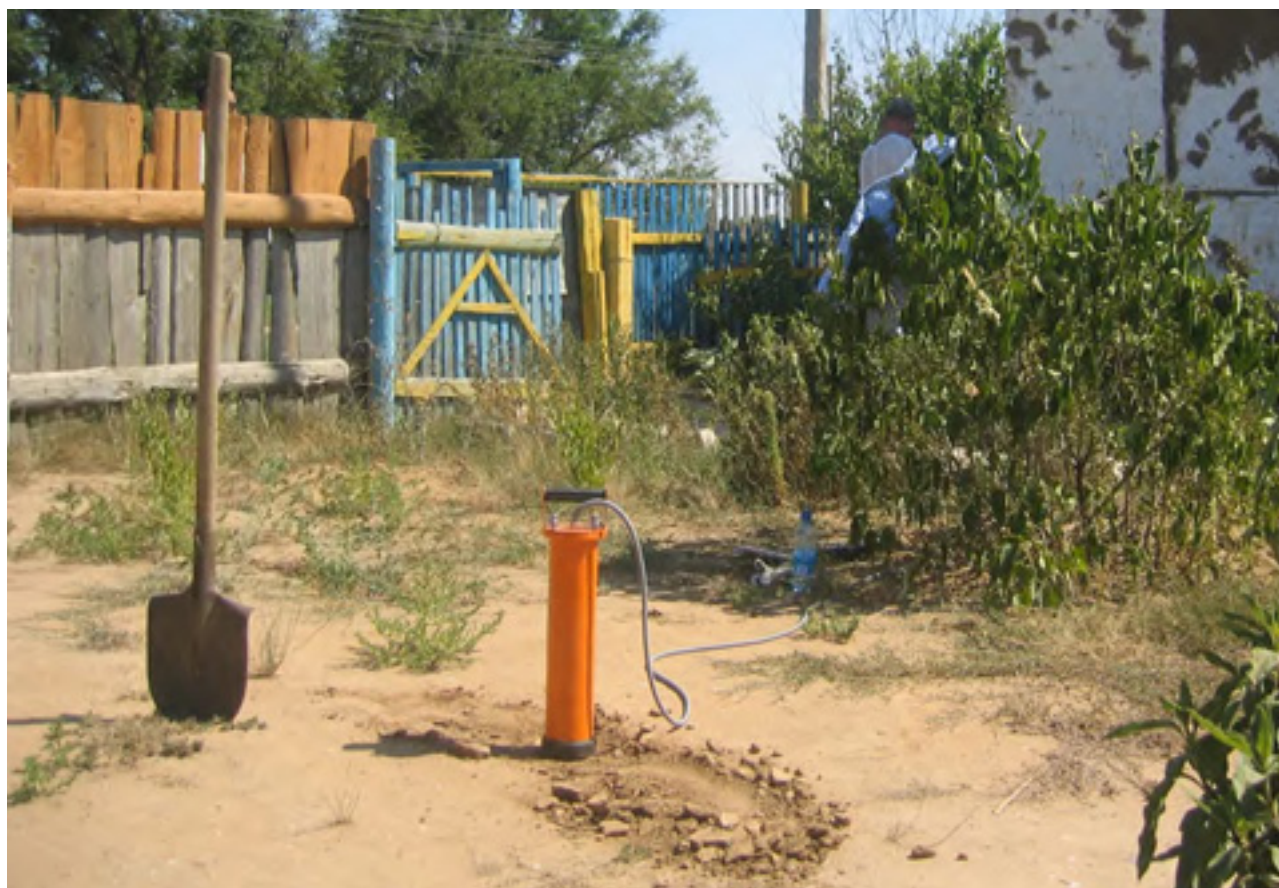
Рис. 6. Полевой гамма-спектрометр МКС-АТ6101Д
