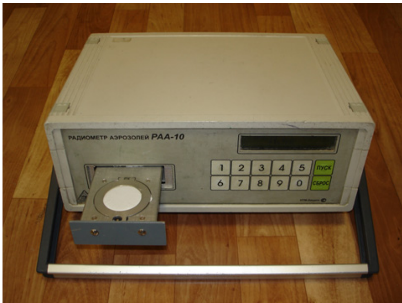
Рис. 4. Радиометр аэрозолей PAA-10
