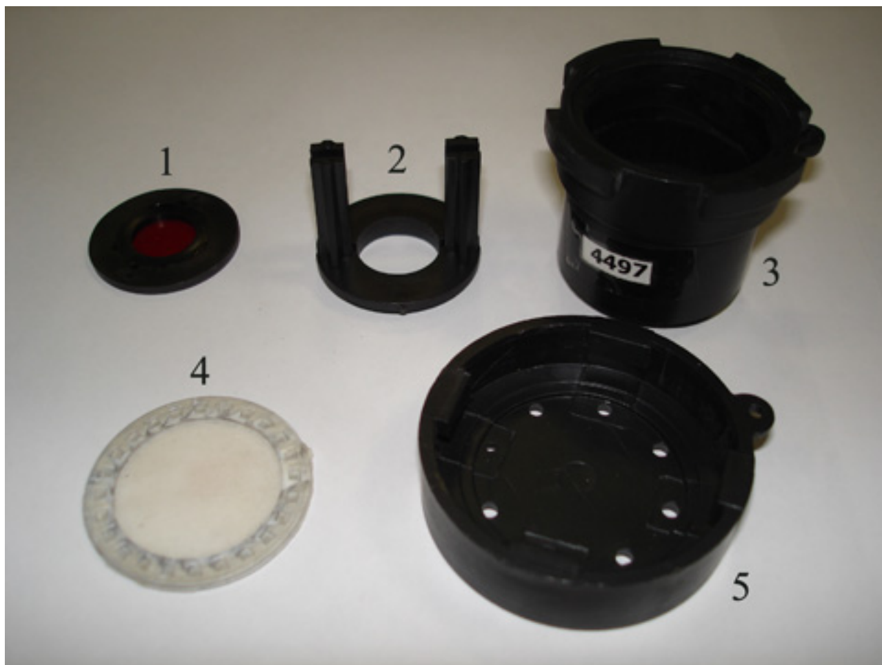
Рис. 5. Конструкция интегрального трекового радиометра радона (ИТРР) разработки ФГУН НИИРГ: 1 – пальцы с пленкой типа LR-115 Туре II; 2 – фиксирующая подставка для пальцев; 3 – цилиндрический пластиковый контейнер; 4 – силиконовая мембрана; 5 – крышка контейнера с отверстиями.
